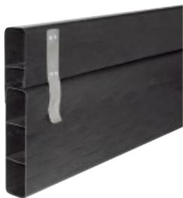
Schal-Drän-Profil aus PVC-U; Farbe schwarz. Einbautiefe bis 4 m möglich. Die Hydraulische Leistung entspricht einem Dränrohr DN 100.
