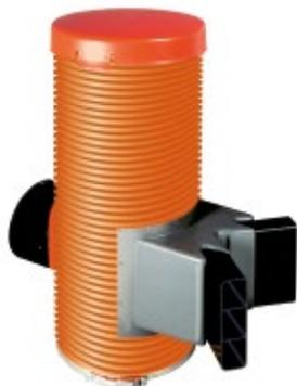
Spül-, Kontroll- und Sammelschacht für fachgerechte Dränanlagen mit Fränkischem Schal- und Dränprofil (FSD), wahlweise für die Anordnung an Gebäudeaußenecken oder Gebäudeinnenecken, wahlweise mit oder ohne Sandfang, Außendurchmesser  $D_A$  315, Bauhöhe 80 cm, Material PVC-U, Farbe orange, mit 2 Stück Anschlussstutzen für FSD-Profil und 1 Stück Ablaufanschluss DN 200 mit Blindstopfen, mit arretierbarer und trittfester Schachtabdeckung aus PP.
