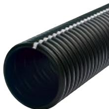
Teilsicker-, Vollsicker- und Mehrzweckrohre aus PE-HD nach DIN 4262-1, Typ R2, Wassereintrittsfläche  $\geq 50 \text{ cm}^2/\text{m}$  für LP, TP, MP, Schlitzbreite  $1,2 \text{ mm} \pm 0,4 \text{ mm}$ . Entsprechend RAS-Ew (Richtlinien für die Anlage von Straßen, Teil: Entwässerung) einsetzbar (SN 4 nach DIN EN ISO 9969).
