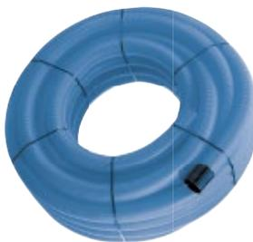
Gewelltes ungelochtes Dränagerohr aus PP; Farbe blau;  $D_A$  80 mm; bzw. 100 mm; Ringsteifigkeit  $\geq 10 \text{ kN/m}^2$  („SN 10“); in Anlehnung an DIN 1187 und DIN 4262-1.
