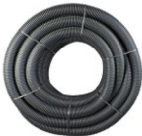
Gewelltes Vollsickerrohr aus PE; Farbe schwarz mit gelber Farbmarkierung;  $D_A$  80 mm; bzw. 100 mm; Ringsteifigkeitsklasse SN 8; Schlitzfläche  $\geq 50 \text{ cm}^2/\text{m}$ ; Schlitzbreite 1,2 mm. In Anlehnung an DIN 1187 und DIN 4262-1.
