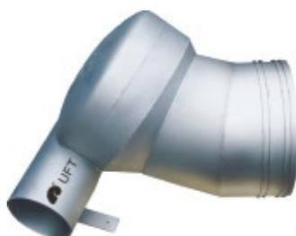
1. Die UFT-Wirbelventile zeichnen sich durch große Abflussöffnungen und eine Spülspitze in der Abflusscharakteristik aus. Es besteht damit keine Verstopfungsgefahr. Der Werkstoff Edelstahl gewährleistet eine maximale Haltbarkeit. Das System ist hochdruckspülbar. Das Wirbelventil hat keine beweglichen Teile und unterliegt damit keinerlei Verschleiß. Dauerhafte Funktion und Wartungsfreundlichkeit sind somit gesichert.
