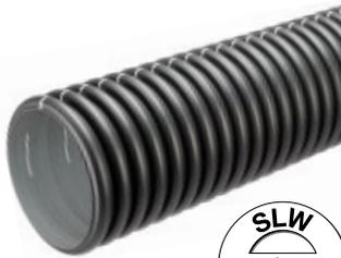
Mehrweckrohr aus PE-HD in Verbundrohrbauweise (außen gewellt, innen glatt) mit Muffe und Profildichtring für wasser-dichte Verbindungen. Farbe außen schwarz, innen grau, mit weißer Scheitelmarkierung.
