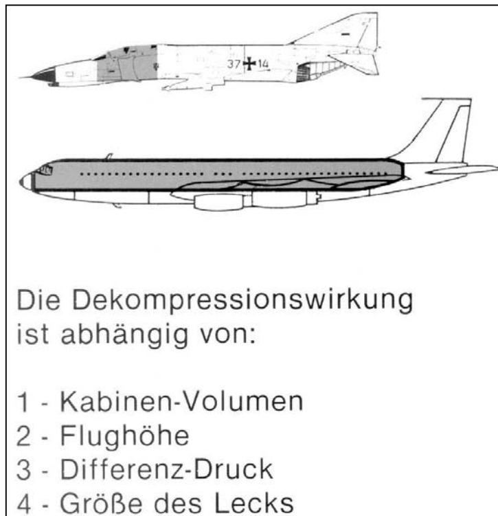
Abb. 4.10: Faktoren einer rapiden Dekompression im Flugzeug
