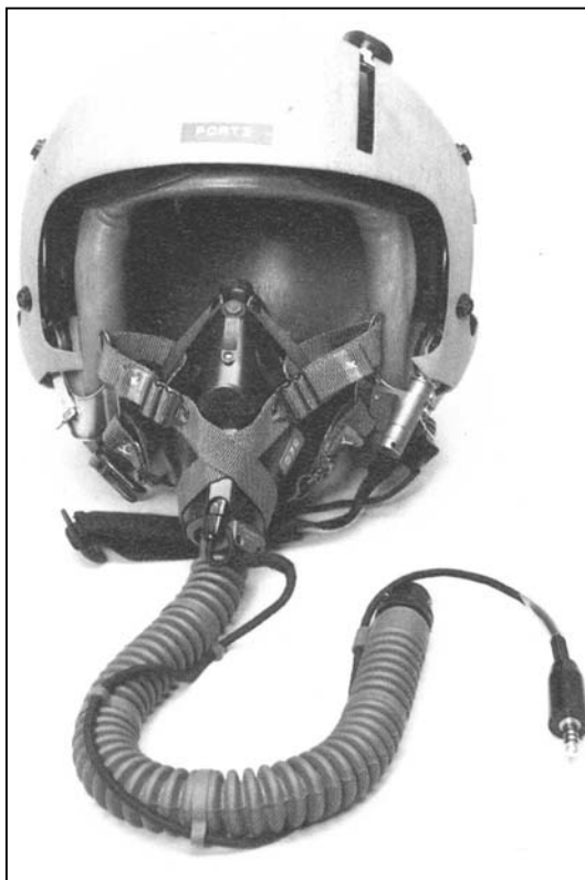
Abb. 4.5: Atemmaske MBU-5/P mit Fliegerhelm HGU-55/G
