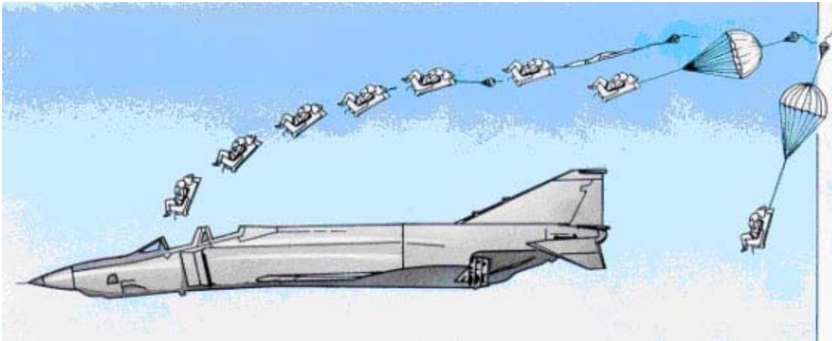
Abb. 7.1: Schematischer Ablauf eines Rettungsausstiegs
