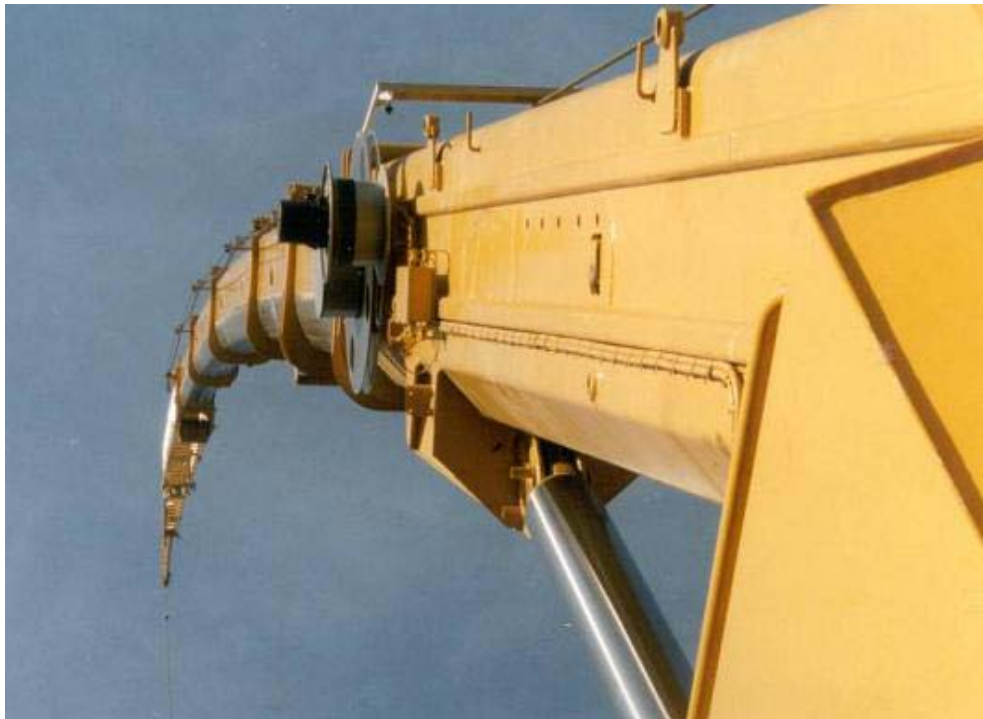
Abb.: Elastische Verformung eines Mobilkranauslegers
