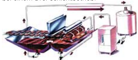
Überzugsanlage in Doppeltrogausführung.
