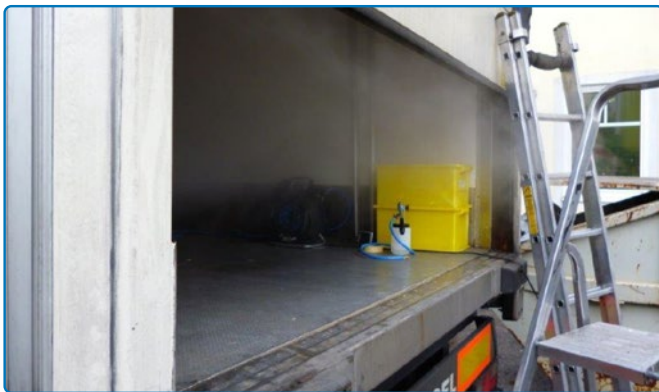
Vernebelung in einem Kühltransporter
