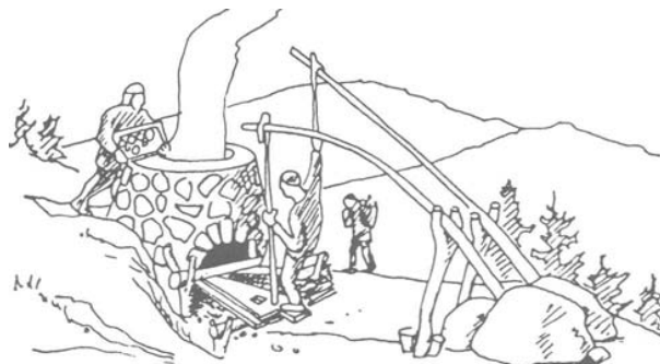
Früh- bis Hochmittelalterlicher Gebläseschachtofen mit Tretbälgen (Feistawiese, Stmk.)
