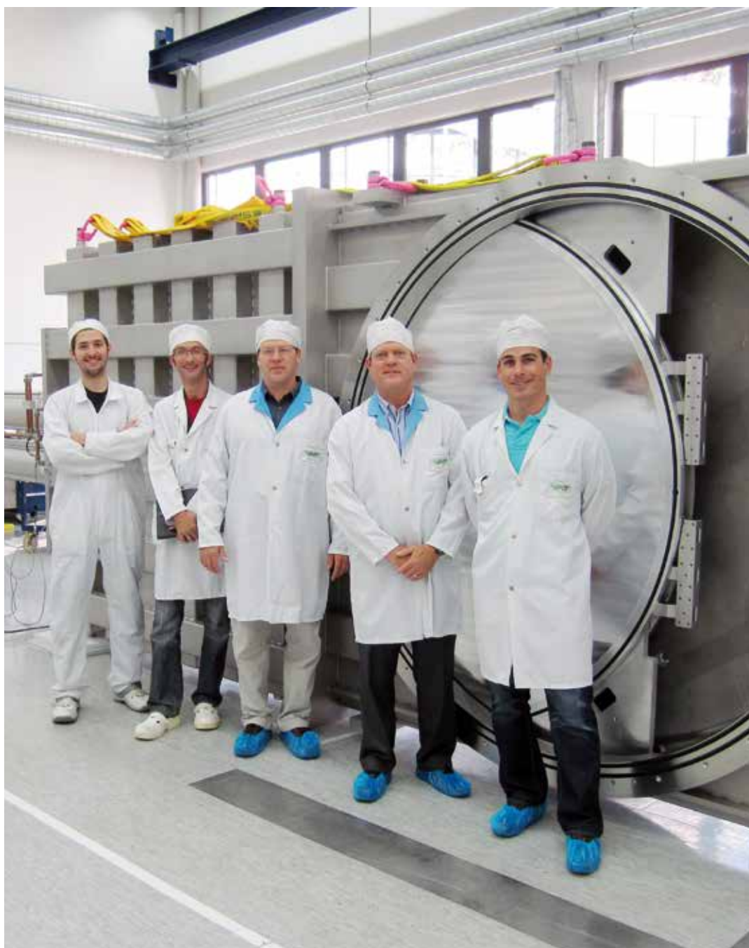
Das grösste von VAT bisher produzierte Schieberventil wird für das Projekt ITER genutzt.
