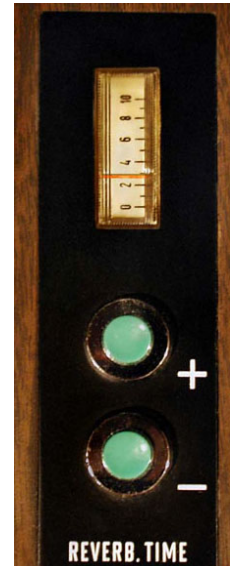
Abbildung 7: Reverb Time Einstellung am EMT 140 (BQ2)
