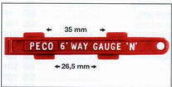
Parallelgleislehre zur exakten Verlegung von Parallelgleisen mit 26,5 oder 35 mm Gleisabstand SL-336
