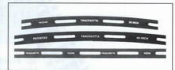
Gleisbauschablonen aus Aluminium Sie sind so konstruiert, dass sie zwischen die Gleisprofile geklemmt werden kön- nen, um das Gleis in den gewünschten Radius zu biegen. Eine ausführliche An- leitung liegt jeder Schablone bei.
