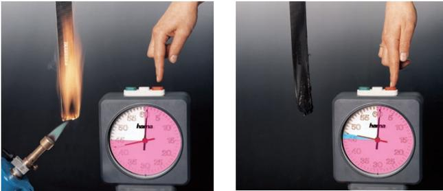
Bei schwer entflammbaren Bändern verlischt das Feuer in wenigen Sekunden (grüner Sektor), nachdem die verwendete Gasflamme entfernt wurde.
