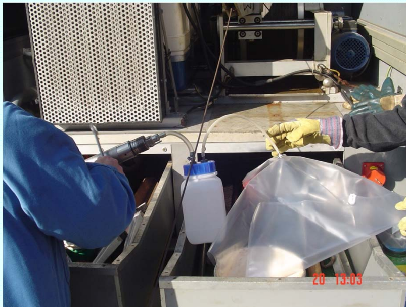
Auffangen des freien Gases mit Gassack
