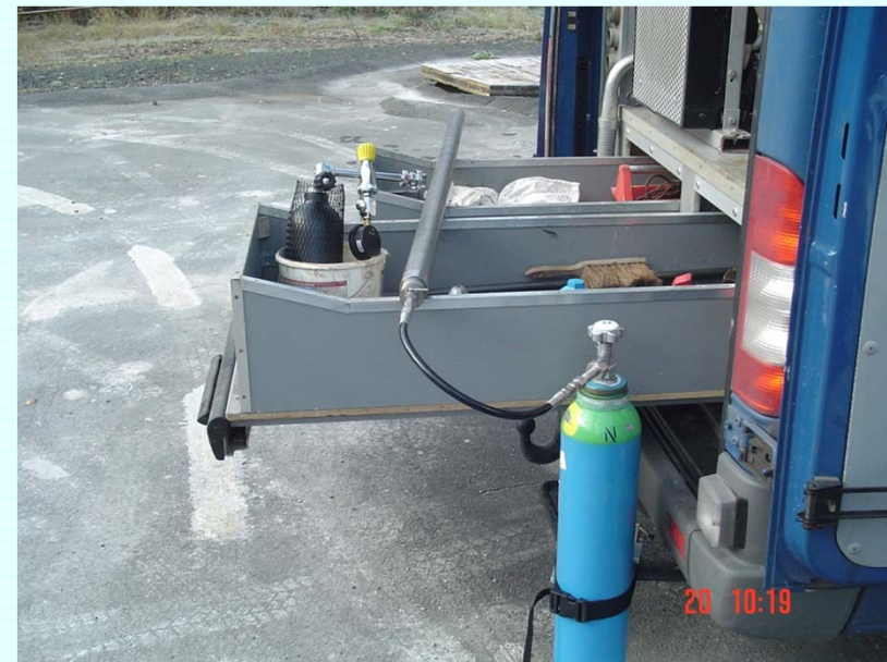
Spülung des Probenehmers mit Neon für repräsentative Probenahme
