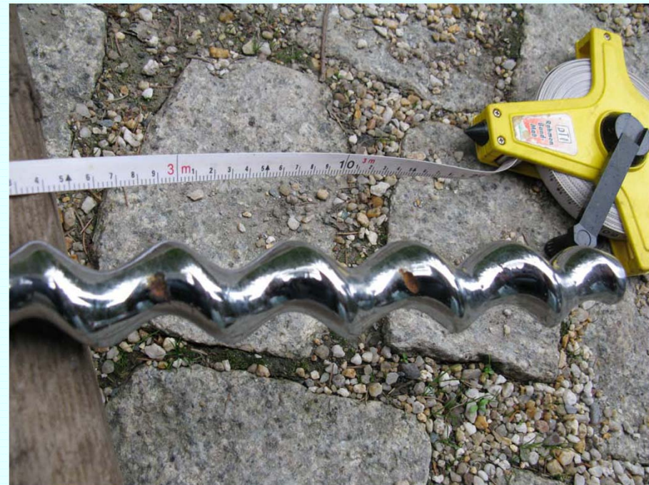
Exzentrerschnecke der Pumpe nach Pumpversuch mit beginnendem Lochfraß
