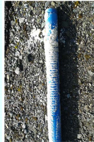
Kristallisation am Pegelrohr des Sammelbehälters (hydraul. Kommunikation zw. DS u. WSP Behälter)
