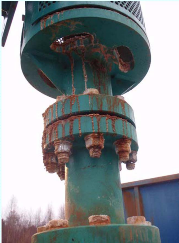
Exzentrerschnecke der Pumpe nach Pumpversuch mit beginnendem Lochfraß
