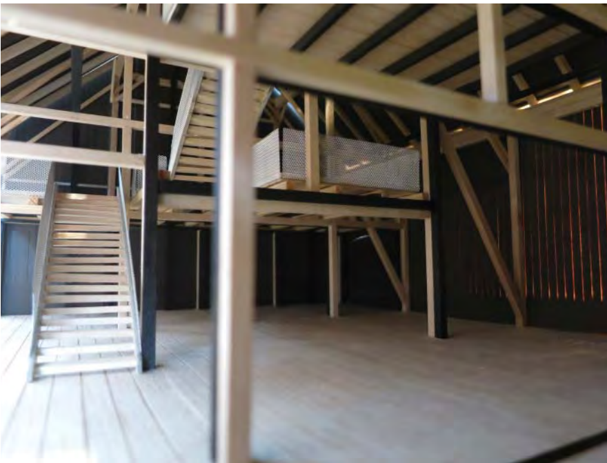
Abb. 80, Ebene +3.42 und Ebene 6.07 (o.), zwei Stiegenläufe verbinden die drei Ebenen (u.).
