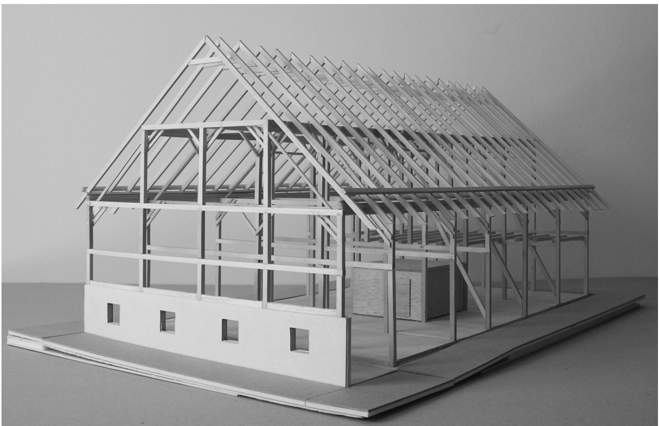
Abb. 37, Die Tragstruktur von Norden (o.) und Süden (u.) aus gesehen.
