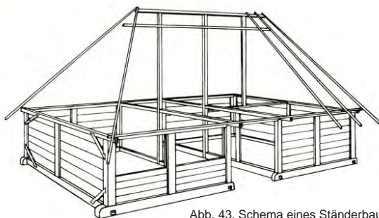
Abb. 43, Schema eines Ständerbaus
