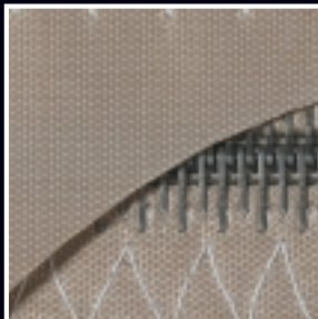
Riemenhaken, mit Zungenüberlappung | Wire-hook, covered
