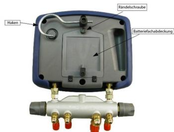
Abb. 6-1. Batteriefachabdeckung
