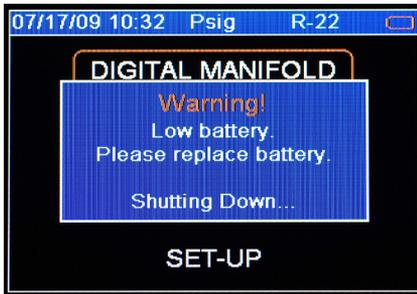
Abb. 2-3. Popup-Fenster bei schwacher Batteriekapazität
