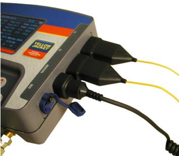
Abb. 2-12. Sensoren mit Schutzkappen
