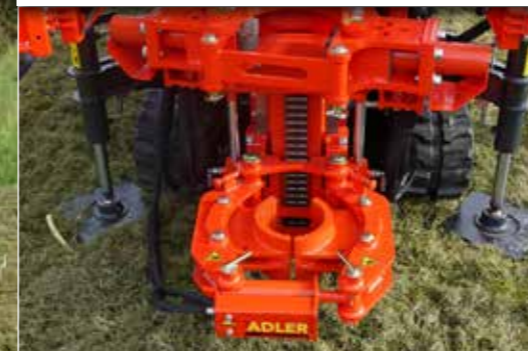
Klemm-Brech-Hubschelle bis 11,8 Tonnen Zugkraft
