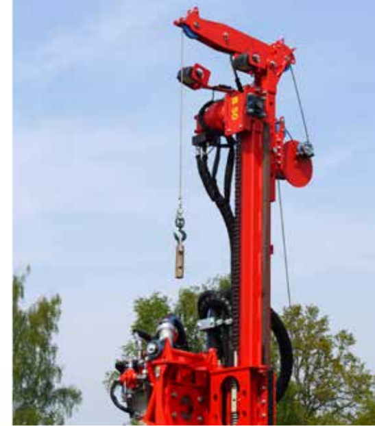
Seilwinde mit Seilschlageinrichtung und Mastverlängerung
