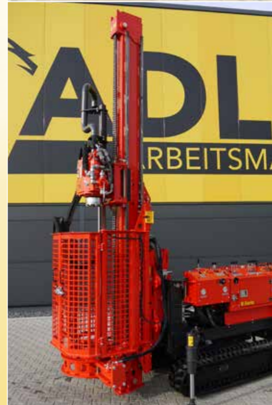
B 50 mit ablenkbarem und seitlich verschwenkbarem Mast
