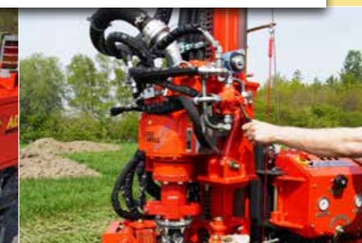
2-stufiger Bohrantrieb mit Drehmomenten bis zu 620 daNm oder Umdrehungen bis zu 210 U/min
