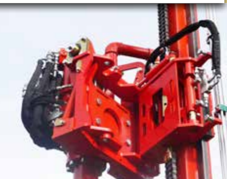
Hydraulische Verschwenkung des Bohrkopfes aus dem Bohrzentrum
