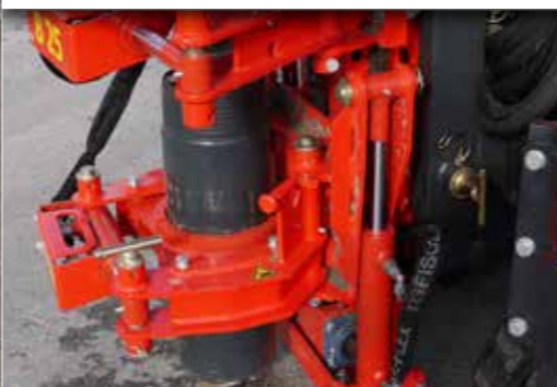
Optional beim B 25: Hubspannschelle für verrohrtes Bohren
