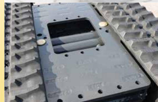
Das Mittelstück des Fahrwerkes verfügt über viele Anschraubpunkte, die kundenspezifisch genutzt werden können.
