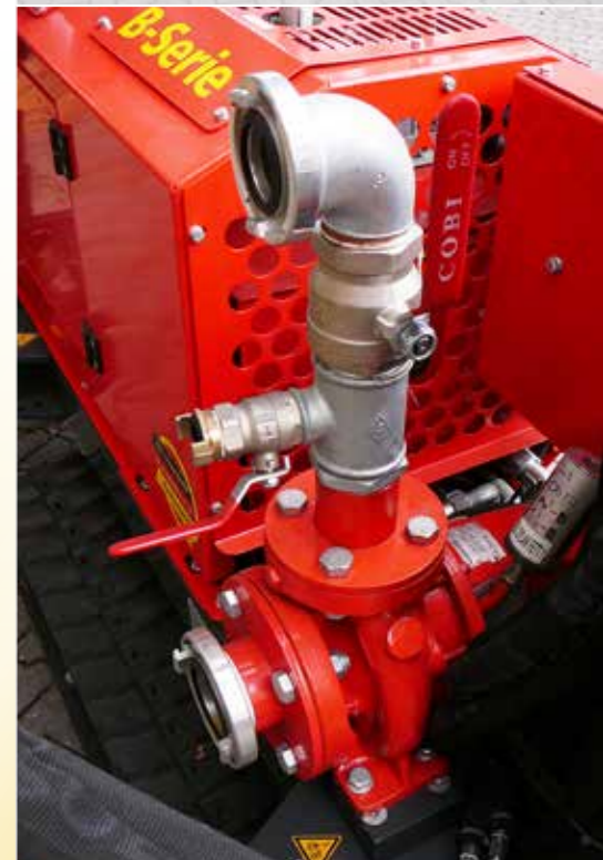
Die Spülpumpe kann auf Wunsch in das Bohrgerät B 15 integriert werden
