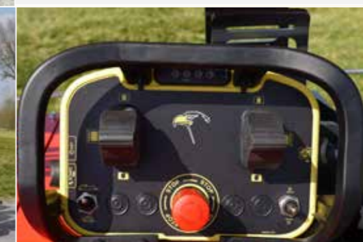
Kabelfernbedienung für den Fahrbetrieb
