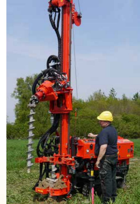
Ausschwenkbarer Getriebebohrkopf mit durchgehender 2 1/2" Spülwelle
