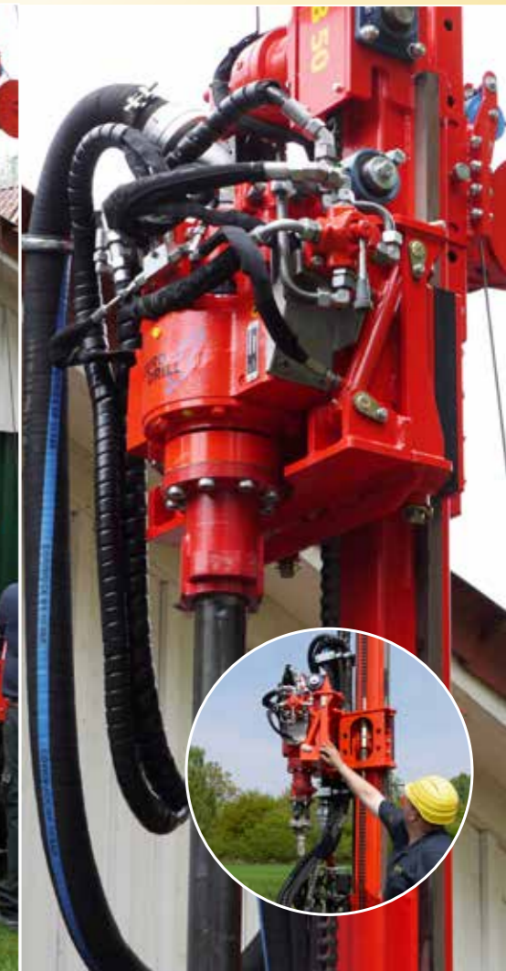
2-stufiger Spülbohrkopf mit Ausschwenkfunktion am B 50
