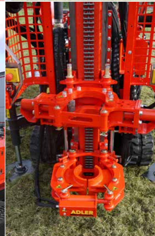
Klemm-Brech-Hubschelle bis 11,8 Tonnen Zugkraft
