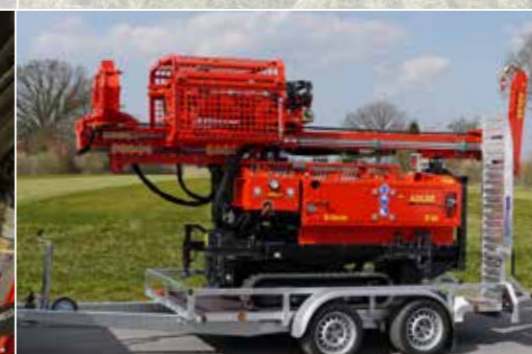
Bohrgerätetransportanhänger Leergewicht 560 kg und zulässiges Gesamtgewicht 3.500 kg, inkl. Verladerampen
