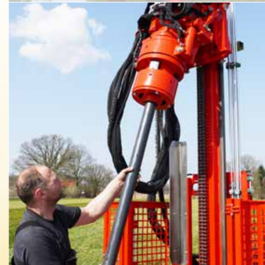
Hydraulische Spannglocke (groß) zum Bohrgestänge und zum Brechen der Aussenverrohrung bis 178 mm
