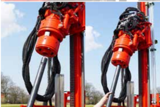
Hydraulische Spannglocke (groß) zum Brechen des Bohrgestänges und der Aussenverrohrung bis 178 mm
