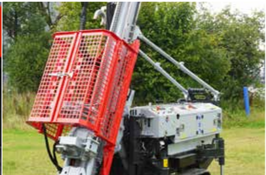
Schrägbohreinrichtung mit Lafettenstützen
