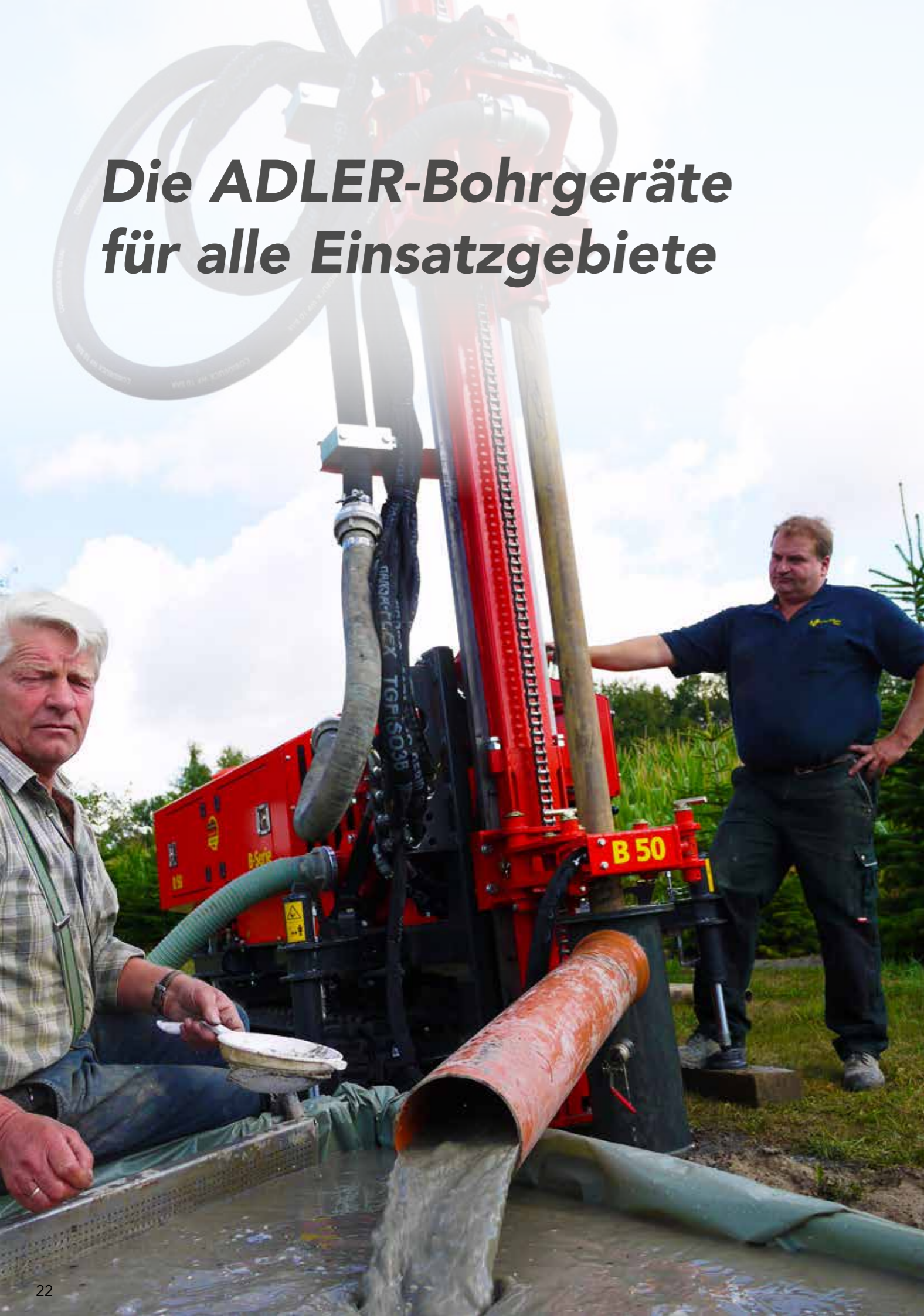
Entnahme von Materialproben aus dem Spülbohrwasser
