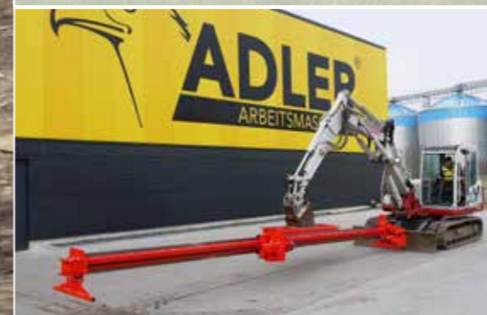
Aufstellen der Bohrlafette ABL mit dem Bagger
