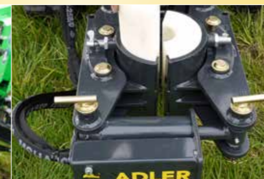
auswechselbare Klemmböcken aus hartem Plastik
