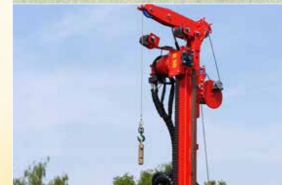
Seilwinde mit Seilschlageinrichtung und Mastverlängerung
