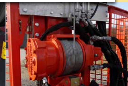
Seilwinde mit 5 kN (500 kg) Zugkraft
