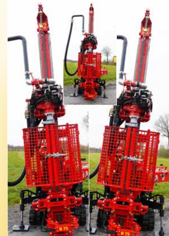
2-D-Mastneigung um 5° (nach vorne und seitlich) serienmäßig
