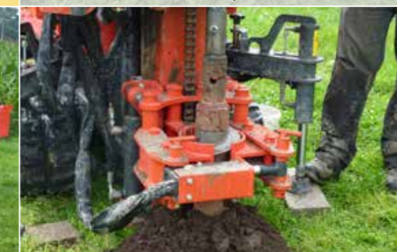
Hohlbohrschnecke geführt durch die Hubspannschelle
