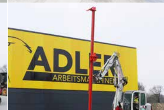
Anbaubohrlafette mit hydraulischer Klemme
