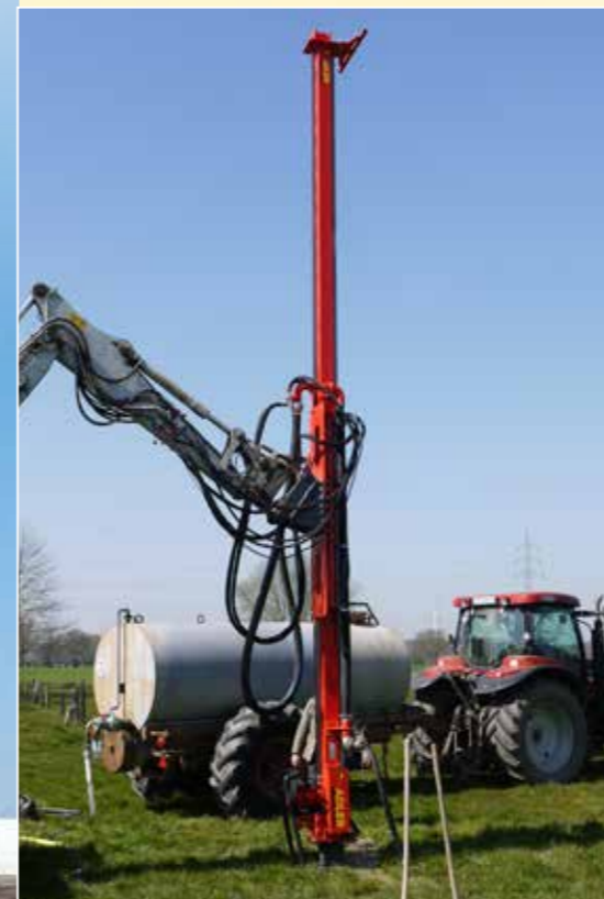
Anbaubohrlafette 6,5 m Verfahrweg am 8 t-Bagger
