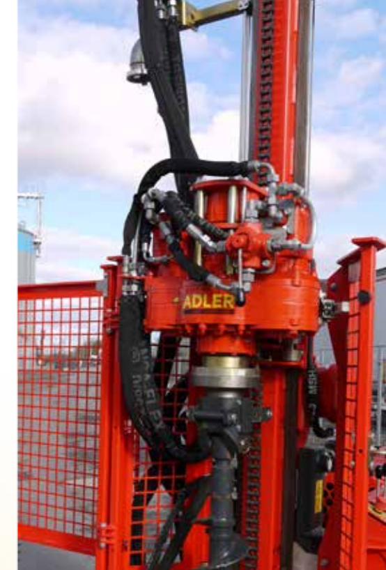
Getriebebohrkopf mit zwei Schaltstufen
