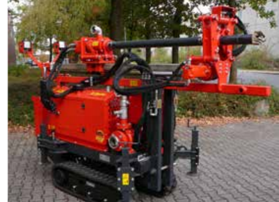
B 15 das kompakte Bohrgerät für oberflächennahe Tiefen
