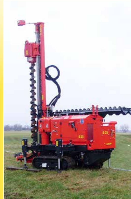
B 25 mit Ablagemagazin für Bohrschnecken
