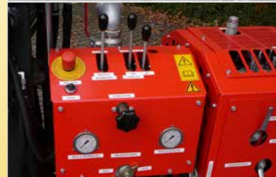
Bedienstand zur Steuerung des Bohrprozesses
