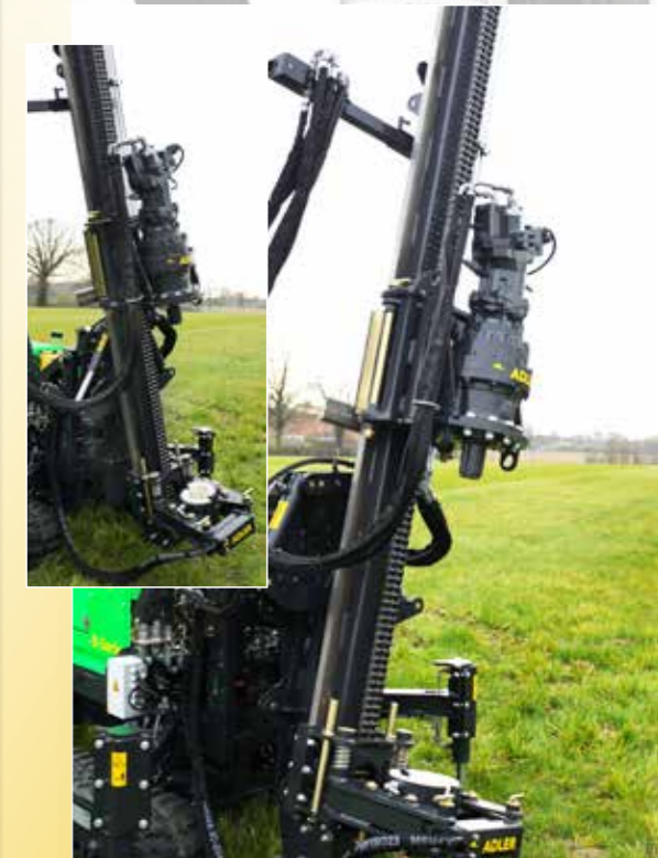
15° Mastneigung nach rechts / links / vorne
