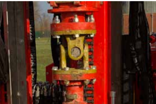
Kreuzgelenk mit BOM 73,5 oben, SW 41/51 unten
