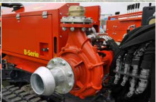
Leistungsstarke Wasserpumpe 120 m 3 /h bei 8 bar - für Wartungsarbeiten ausziehbar
