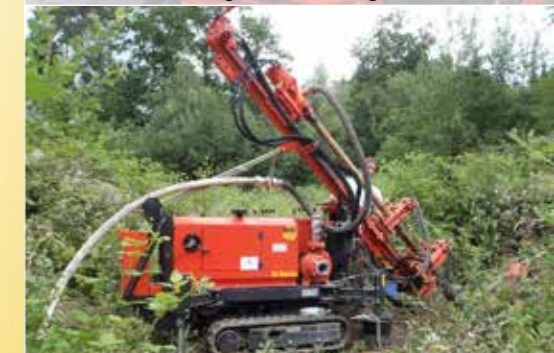
B 25 mit Schrägbohrereinrichtung
