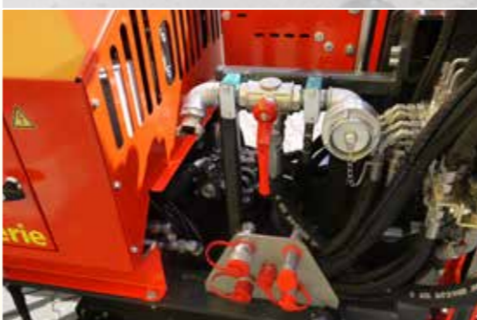
Umschaltung Wasser auf Druckluft und zusätzliche hydraulische Anschlüsse für Zubehör
