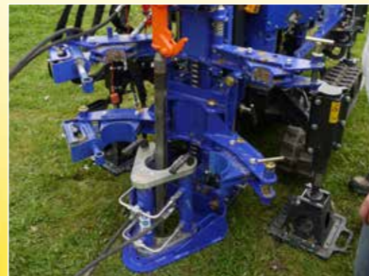
Rammkernsondierung mittels Schlaghammer
