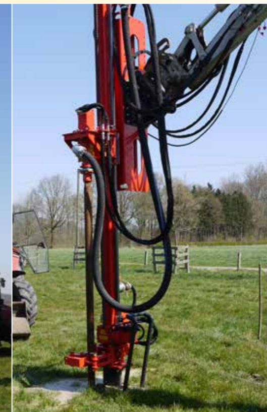
Anbaubohrlafette im Bohrprozess am Bagger
