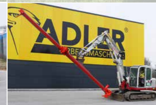
Anbaubohrlafette im Bohrprozess am Bagger
