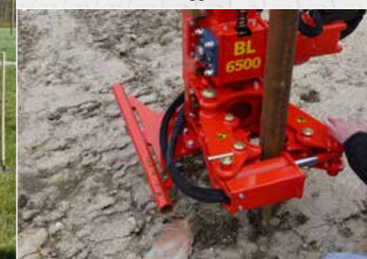
Anbaubohrlafette mit hydraulischer Klemme
