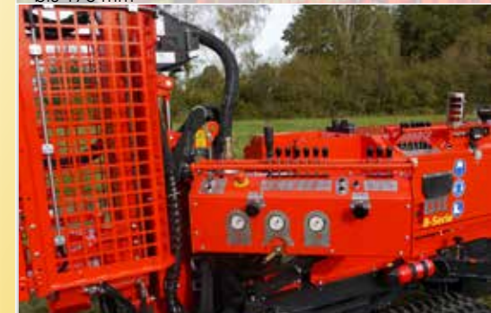
Serienmäßig mit ausschwenkbarem Bedienpult. Optional Steuerung auch komplett über Kabelfernbedienung möglich
