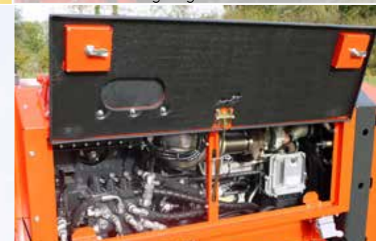
Bohrgerät B75 ausgestattet mit 75 PS, 2,9 Liter Deutz-Motor der neuesten Abgasstufe 5
