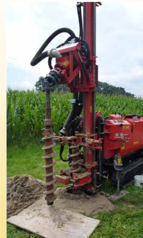
Einfaches Ausbauen der Hohlbohrschnecke durch schwenkbaren Bohrkopf
