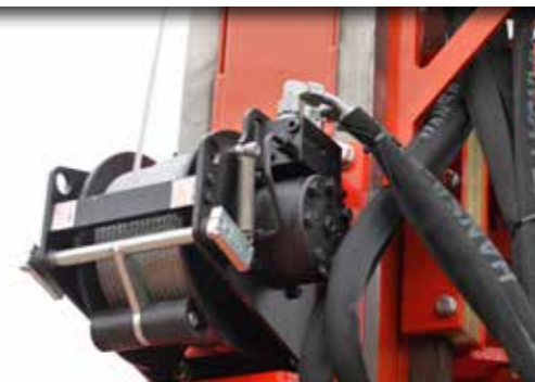
Seilwinde mit 500 kg oder 1000 kg Zugkraft auf Wunsch
