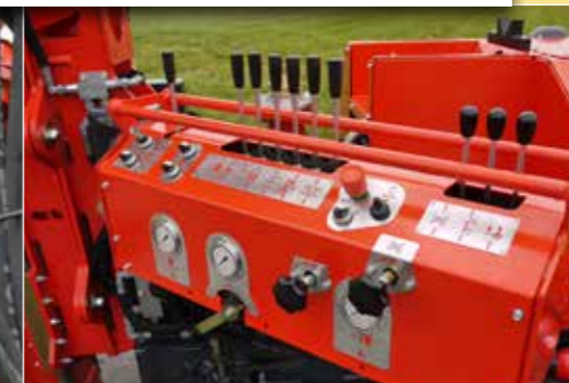
Bedienpult ausschenkbar zur Steuerung aller wichtigen Bohrfunktionen
