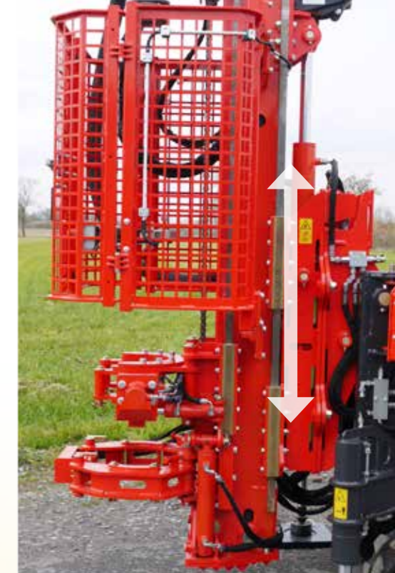
Mastabsenkung um 300 mm beim B75 pro serienmäßig
