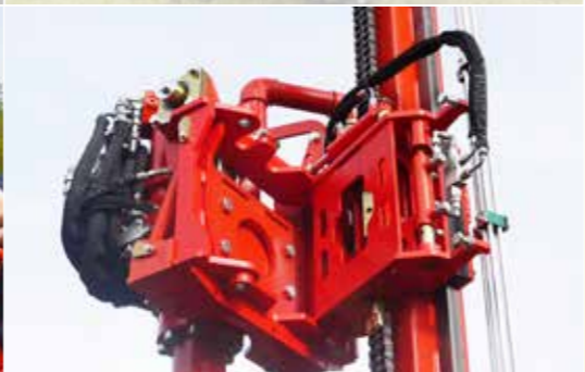
Hydraulische Verschwenkung des Bohrkopfes aus dem Bohrzentrum
