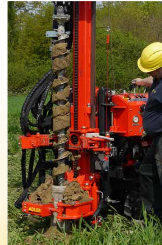
Einfache Ansteuerung der Bohrschnecke über den Steuerstand
