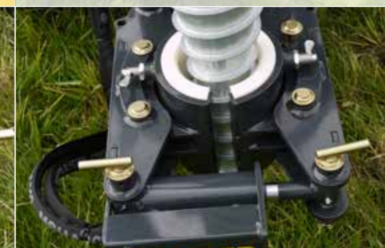
hydraulische Klemme zum Führen der Schraubfundamente
