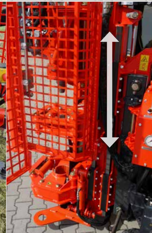
Hydraulische Mastabsenkung 300 mm beim B 50 und B 75
