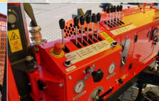
Bedienstand mit allen Bohrfunktionen – schwenkbar
