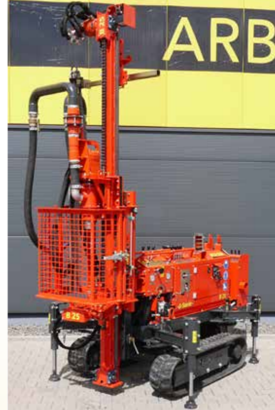
ADLER-Bohrgerät auf ADLER-Raupenfahrwerk
