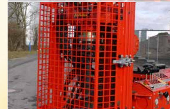
Schutzeinrichtung im Bereich des drehenden Gestänges serienmäßig
