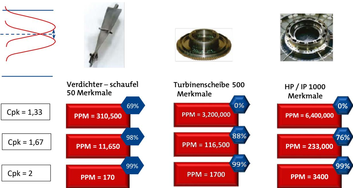
Abbildung 11 zeigt einen ausführlicheren Vergleich des Zusammenhangs zwischen Cpk-Werten und PPM. Wichtig ist die Spalte ganz rechts. Sie zeigt die Teile pro Million Defekte, wenn der Prozess um plus oder minus 1,5 Standardabweichungen vom Nennwert (mittleres Drittel der Kontrollgrenzen) variieren dürfte. Dies ist eine realistischere Berechnung, da die meisten Prozesse bis zu einem gewissen Grad während der Produktion um den Nennwert variieren.
