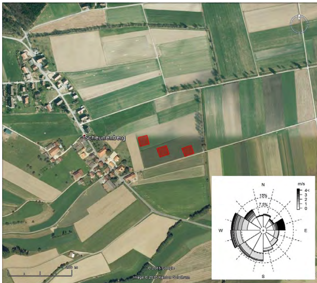
Abbildung A.65: Anordnung der Versuchspartellen. Die Windrosengrafik zeigt die Frequenz der Windrichtung, sowie die dazugehörigen Windgeschwindigkeiten (in m/s) auf 1 m über Boden, welche über die gesamte Versuchsdauer gemessen wurden.
