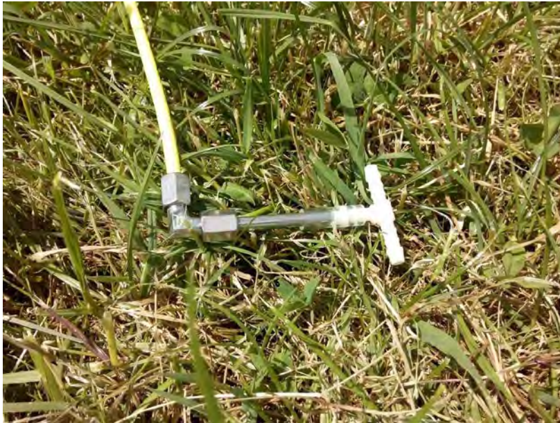
Abbildung 15: Detailansicht Auslass der kritischen Düse auf einer Grasoberfläche.
