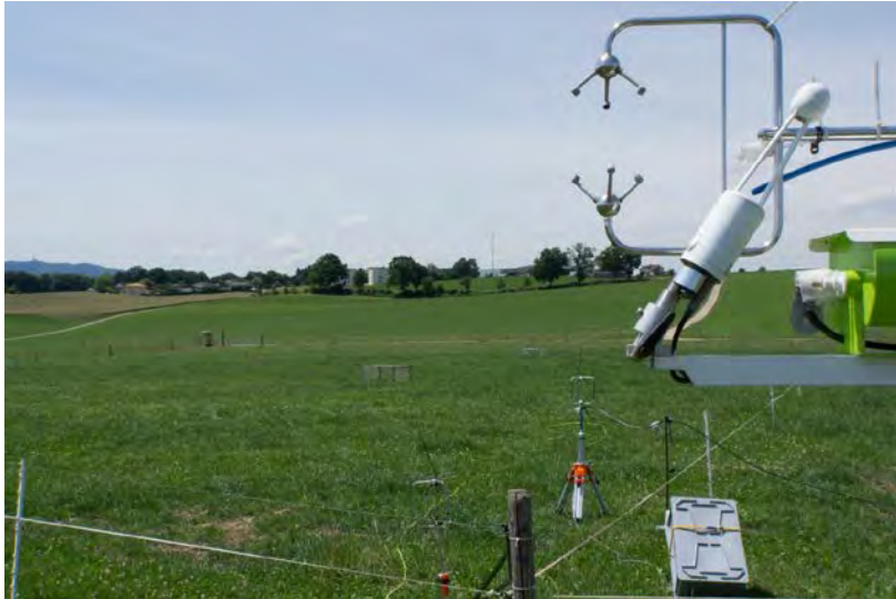
Abbildung 16: Bestimmung der Wiederfindungsrate von \text{CH}_4 mittels künstlicher Quelle, Versuch vom 25.06. - 29.06.2014 in Posieux.
