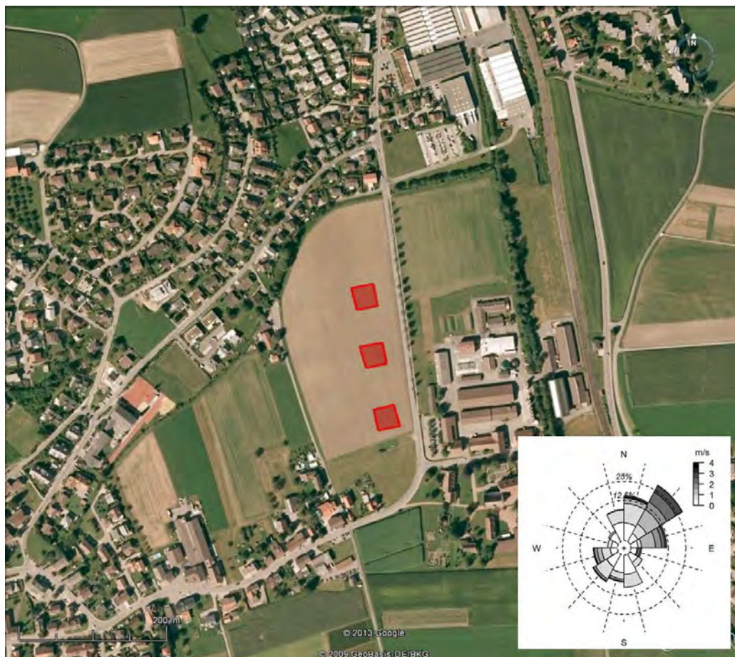
Abbildung A.41: Anordnung der Versuchspartellen. Die Windrosengrafik zeigt die Frequenz der Windrichtung, sowie die dazugehörigen Windgeschwindigkeiten (in m/s) auf 1 m über Boden, welche über die gesamte Versuchsdauer gemessen wurden.
