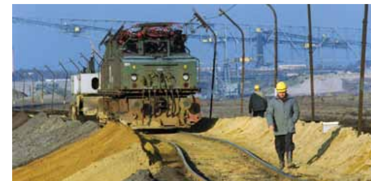
E-Lok EL 2 4-961 mit einem Birkpflug beim Reinigen des Kippgleises im Tagebau Klettwitz, 1996 Böschungssanierung im Tagebau Seese-Ost, 1997
