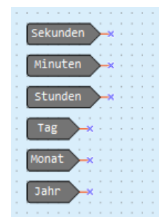
Abb. 5.7 Servicevariablen im Schaltbild
