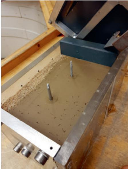
**Modellaufbau: Tonmodell L x B ca. 200 x 150 mm; Modelltiefe 120 mm; Pfahl-Aussendurchmesser Schraubpfahl 5,5 mm, glatter Pfahl 5,5 mm; Pfahllänge 90 mm.**
