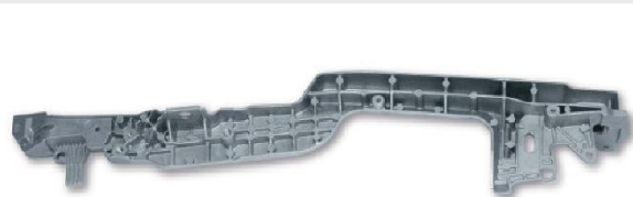
Cabrioledckel Magsimal-59, Gusszustand Druckguss, Wanddicke 2-5 mm 740 x 150 x 125 mm, Gewicht: 1,2 kg
