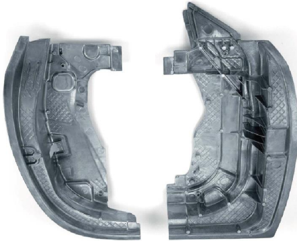
Türschwelle eines Sportwagens Castasil-37 Druckguss 620 x 340 x 170mm, Gewicht: 1,2kg 700 x 340 x 170mm, Gewicht: 2,1kg
