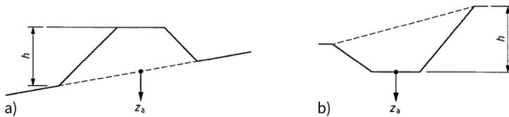
**Bild 63** Definition der Untersuchungstiefe  $z_a$  und der Bauwerkshöhe  $h$  gemäß Eurocode 7 [78];
