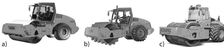
**Bild 65** a) Glattmantelbandage [26], b) Stampffußbandage [26], c) Polygonbandage [13] (nach [6])
