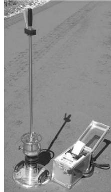
**Bild 76** Komponenten des Leichten Fallgewichtsgeräts (nach [1])
