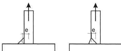
b) Zugkraft erzeugt Zug in der Schweißnahtwurzel
