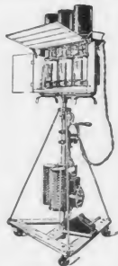
FOTOFILM- Aufnahmeständer mit 3 Hochspannungslampen
