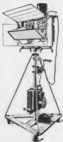
FOTOFILM- Aufnahmeständer mit 4 offenen Lichtbogen
