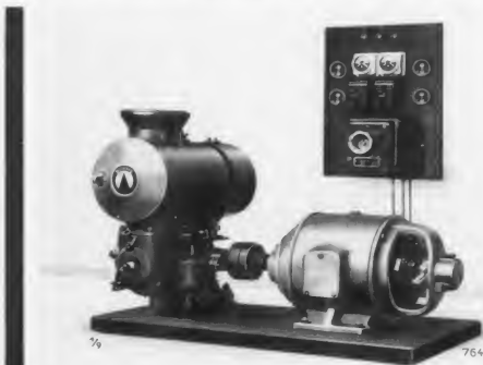
Wassergekühlter Böhme-Kleinmotor mit Dynamo gekuppelt
