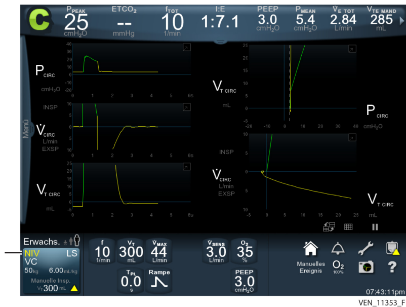
Abbildung 4-9. Taste für Setup-Bildschirm des Beatmungsgeräts, „NIV“ zeigt NIV-Beatmungstyp an
