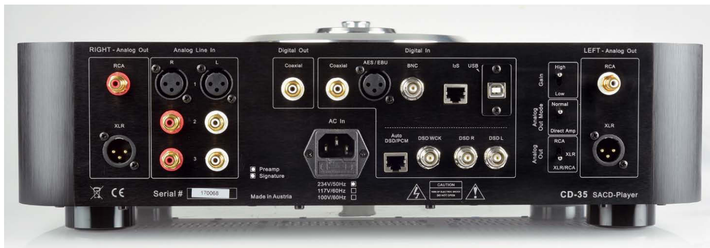
Die untere Reihe der insgesamt fünf digitalen Eingänge gehört einer professionellen DSD-Schnittstelle mit getrennter Clock. Insgesamt drei analoge Eingänge (links), einer davon symmetrisch, laufen über die Ausgangsverstärker und den Vierfach-Pegelsteller.
