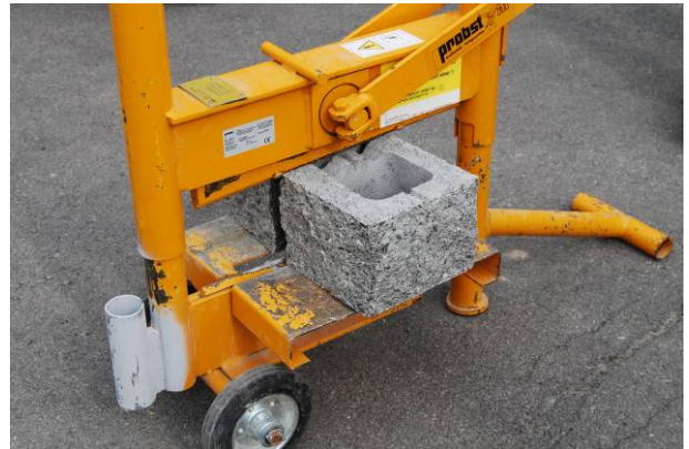
Bild 54: Trennen der Spaltsteine mit Steinspalter
