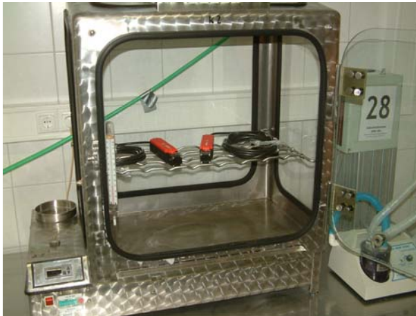
Bild 13 „Safety Switch“ Prüflinge Nr. 1 und 2 in der Salznebelkammer SNK 28 während der Beanspruchung mit Salznebel
