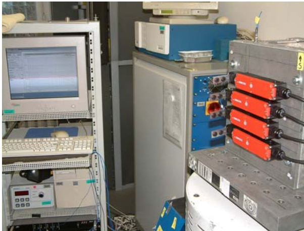
Bild 7 Prüflinge Nr. 3 bis 6 auf dem Schwingtisch der Schwingprüfanlage TIRAvib 5142 bei den mechanischen Prüfungen in der S-Achse
