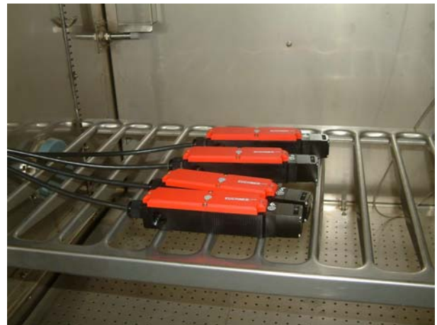
Bild 4 Prüflinge Nr. 3 bis 6 in der Klimaprüfkammer KPK 5 bei den klimatischen Prüfungen
