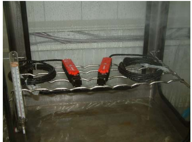
Bild 14 „Safety Switch“ Prüflinge Nr. 1 und 2 in der Salznebelkammer SNK 28 während der Beanspruchung mit Salznebel
