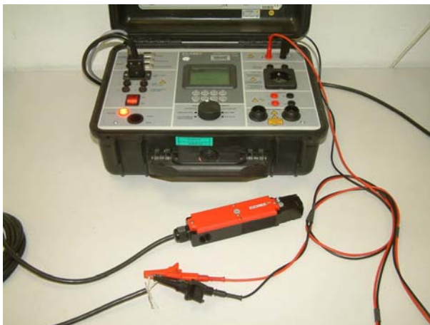
Bild 5 Prüfling Nr. 5 mit Portable Compact Tester 91-4A während der Isolationsmessung nach der klimatischen Beanspruchung Db
