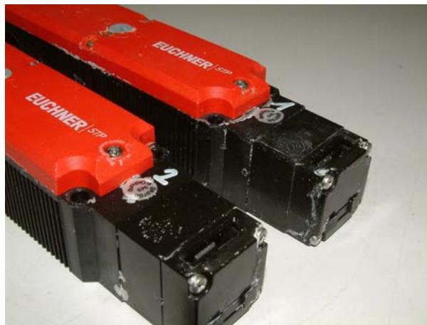
Bild 17 „Safety Switch“ Prüflinge Nr. 1 und 2 ohne erkennbare Oberflächenveränderungen nach der Beanspruchung mit Salznebel
