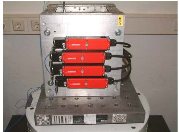
Bild 8 Prüflinge Nr. 3 bis 6 auf dem Schwingtisch mit angeschlossenen Beschleunigungssensoren bei den mechanischen Prüfungen in der S-Achse
