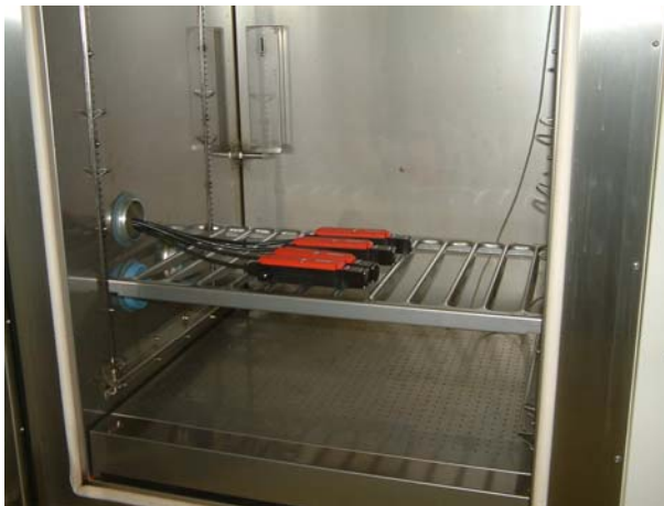
Bild 3 Prüflinge Nr. 3 bis 6 in der Klimaprüfkammer KPK 5 bei den klimatischen Prüfungen
