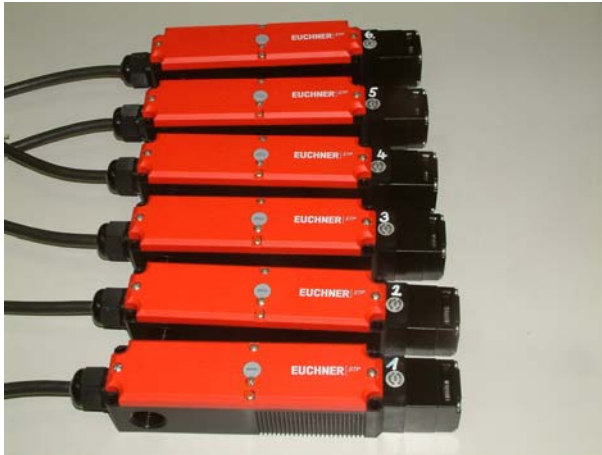
Bild 1 Sicherheitschalter „Safety Switch“ Prüflinge Nr. 1 bis 6 Anlieferungszustand
