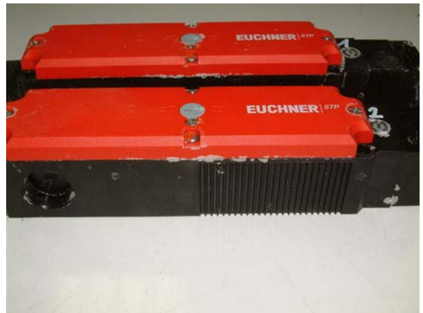
Bild 16 „Safety Switch“ Prüflinge Nr. 1 und 2 mit erkenn- baren Salzablagerungen auf der Oberfläche nach der Beanspruchung mit Salznebel
