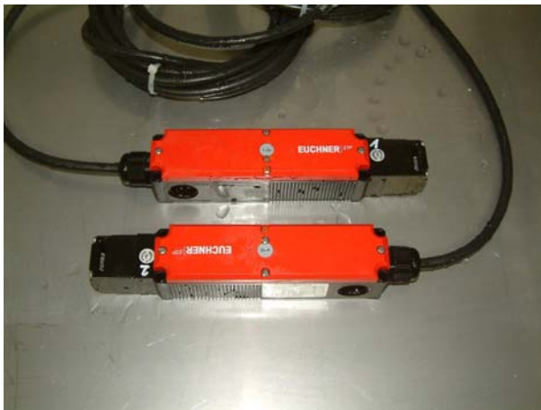
Bild 15 „Safety Switch“ Prüflinge Nr. 1 und 2 mit klarem Wasser abgespült nach der Beanspruchung mit Salznebel
