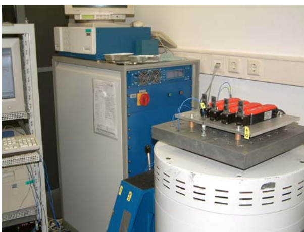
Bild 11 Prüflinge Nr. 3 bis 6 auf dem Schwingtisch der Schwingprüfanlage TIRAvib 5142 bei den mechanischen Prüfungen in der L-Achse
