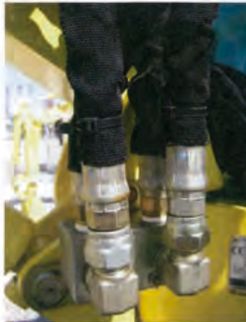
Bild 5: Bei einseitigem Verschließen des Schutzschlauches ist die Funktionssicherheit noch gegeben, bei beidseitigem Verschließen jedoch nicht.
