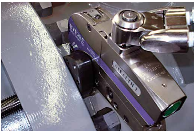
↑ STEALTH-2 mit DISC-Unterlegscheibe am Behälterdeckel
