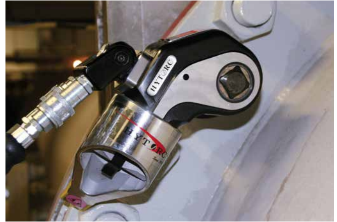
↑ EDGE-4 am Gehäuseflansch einer Umformmaschine
