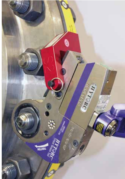
↑ STEALTH – Abstützen außen am Flanschumfang
