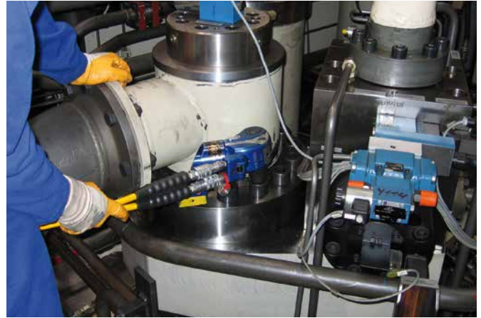
↑ Ideal für Schrauben ISO4762: der kleine Kopfradius des MXT
