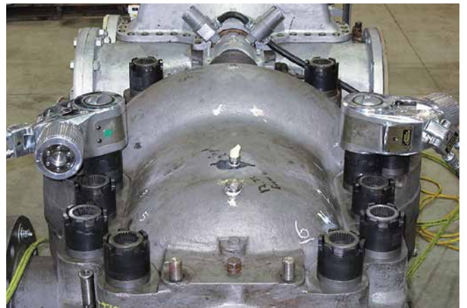
↑ Torsionsfreies Vorspannen der Gehäuseschrauben
