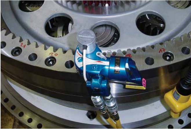
↑ Anziehverfahren: Drehmoment-Drehwinkel mit MXT-1 im Getriebebau
