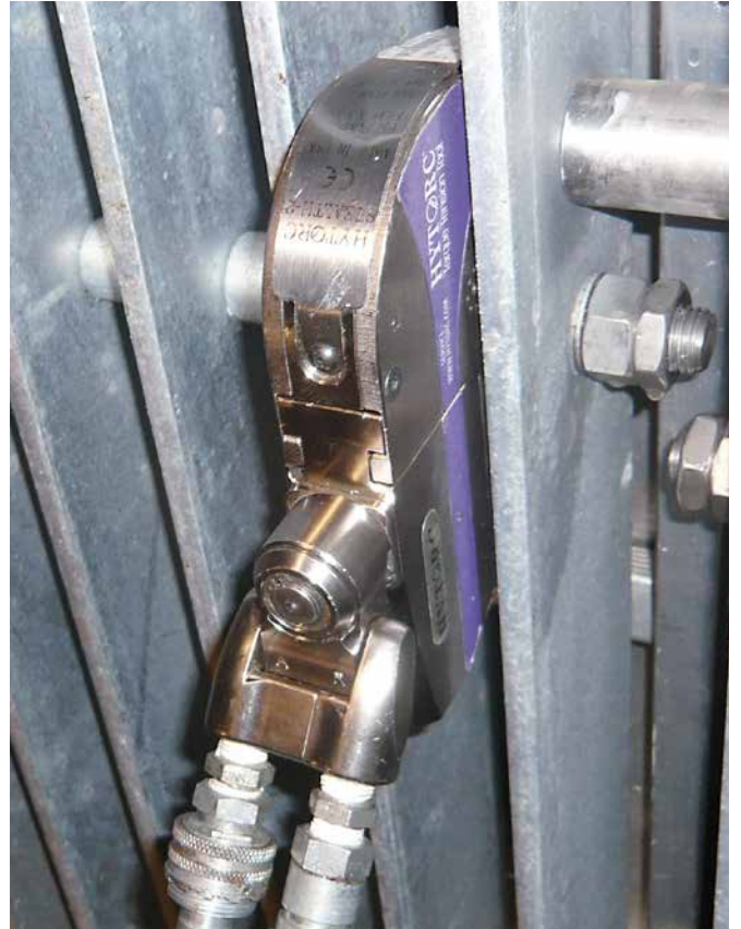
↑ Der STEALTH ist ideal für platzbeengte Verschraubungen
