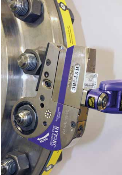
↑ STEALTH – Abstützen an der nächsten Schraubverbindung
