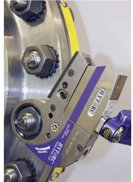
↑ STEALTH – Abstützen an der verdrehsicheren Unterlegscheibe
