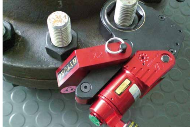
↑ XLCT-2 mit seitlicher Abstützung am Flansch
