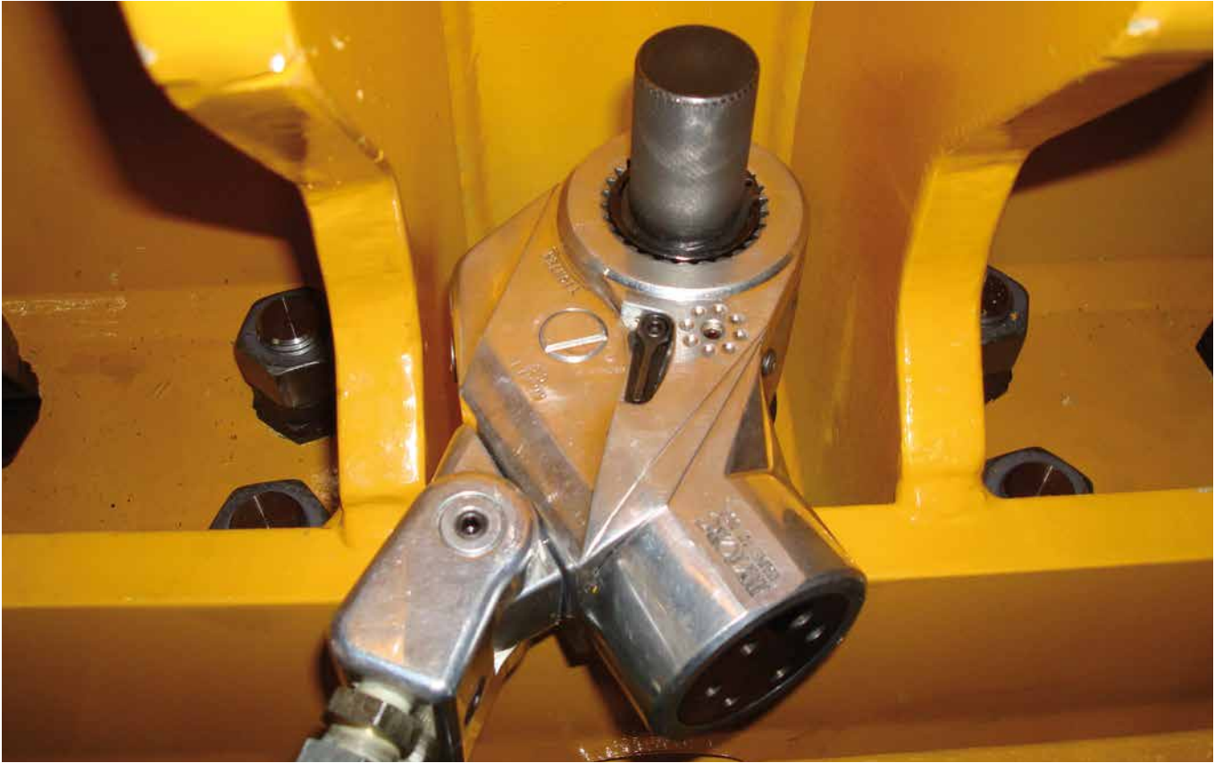
↑ Verschrauben ohne Abstützarm – Schnell. Sicher. Auf kleinstem Raum.
