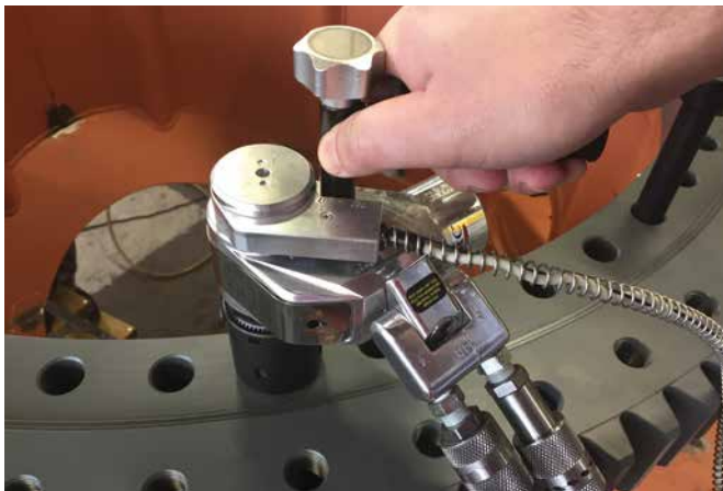
↑ AVANTI-1 für Drehmoment-Drehwinkel am Drehkranz
