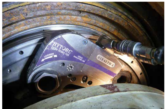
↑ Der STEALTH ist ideal für Inbusverschraubungen
