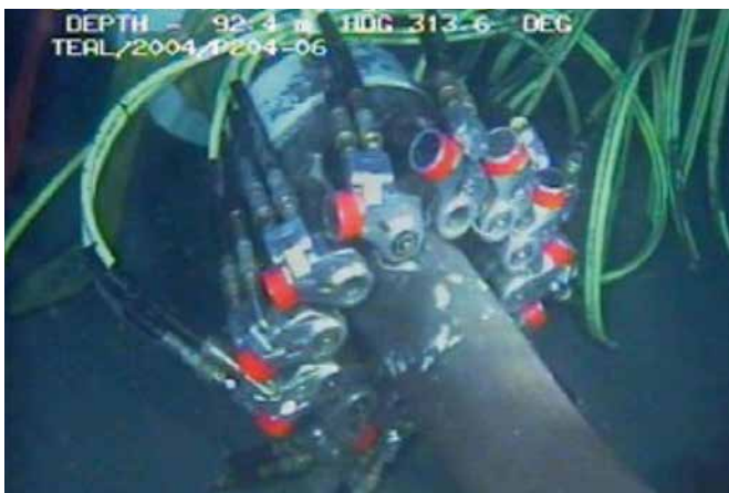
↑ AVANTI-1 SIMULTORC für den Subsea-Einsatz
