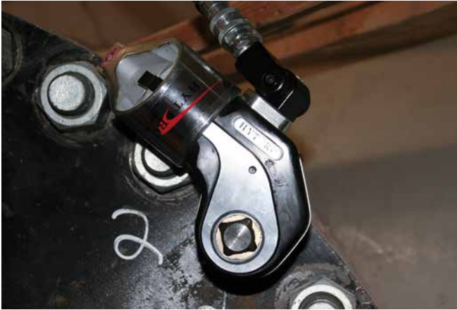
↑ EDGE-2 bei der Flanschverschraubung
