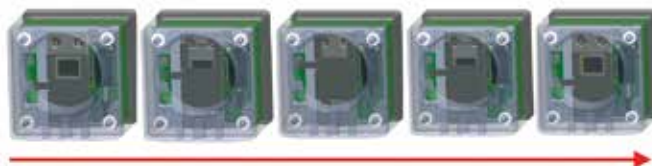
Zur Offsetreferenzierung wird das Gesichtsfeld des Infrarot-Sensorarrays mittels Linearmotor kurzzeitig geschlossen
