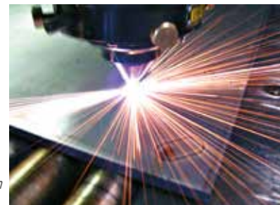
Infrarottemperaturmessung beim Laserschweißen
