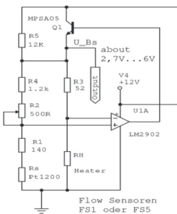
Die beiden Elemente (Heizer RH und Sensor RS) können in einer Brücke verschaltet werden. Die Widerstände R1, R2 und R3 sind richtig zu dimensionieren um die Brücke bei einer wählbaren Temperaturdifferenz ( $\Delta T$ ) zwischen RS und RH abzugleichen. Dies ist der Zustand auf den die an der Brücke anliegende Spannung geregelt wird.
