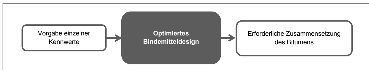
Bild 39: Grundlegende Idee des synthetischen Bindemitteldesigns
