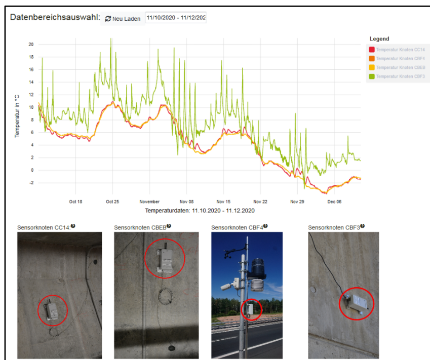
Bild 173: Darstellung der Messergebnisse in der Web-Publikation beispielhaft für die Temperaturdaten der Sensoren CC14; CBEB, CBF4 und CBF3.
