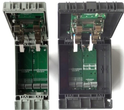
Bild 161: Vergleich der verschiedenen Gehäusegrößen, Gehäuse an der Intelligenten Brücke im digitalen Testfeld Autobahn (links), Gehäuse an einer Brücke in Bad Segenberg (rechts)
