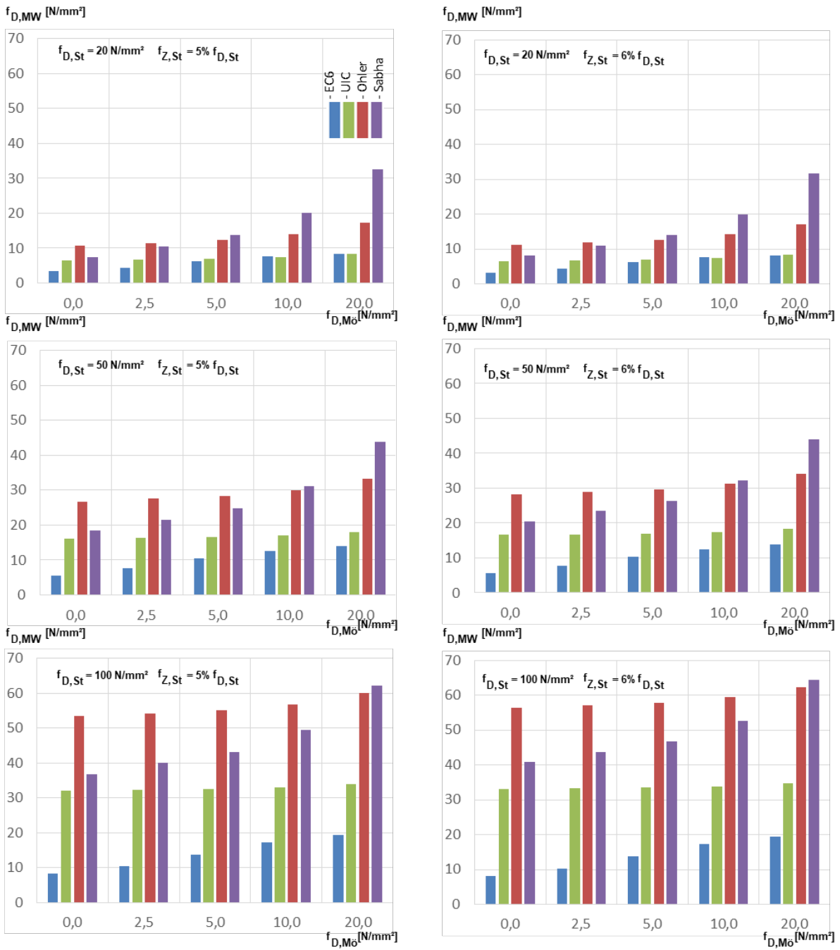
Bild 74 Vergleich der Tragfähigkeit unter zentrischer Beanspruchung, Geometrie d_{St}/h_{St}/t = 30/30/1,5 cm, Steinzugfestigkeit im Verhältnis zur Steindruckfestigkeit f_{Z,St} = 5\% bzw. 6\% f_{D,St}
