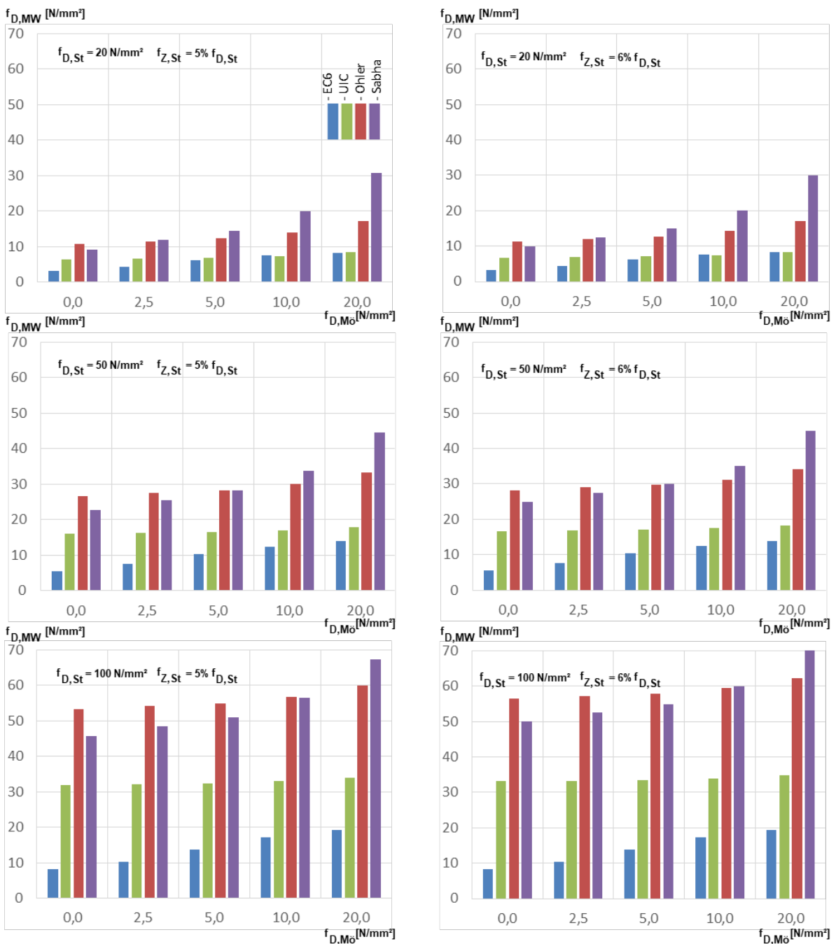
Bild 77 Vergleich der Tragfähigkeit unter zentrischer Beanspruchung, Geometrie d_{St}/h_{St}/t = 60/30/1,5 cm, Steinzugfestigkeit im Verhältnis zur Steindruckfestigkeit f_{Z,St} = 5\% bzw. 6\% f_{D,St}
