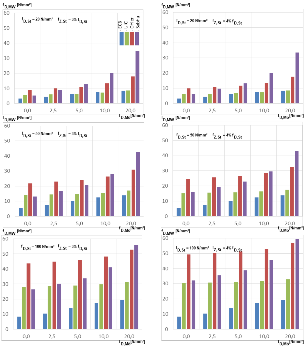
Bild 73 Vergleich der Tragfähigkeit unter zentrischer Beanspruchung, Geometrie d_{St}/h_{St}/t = 30/30/1,5\text{cm} , Steingzugfestigkeit im Verhältnis zur Steindruckfestigkeit f_{Z,St} = 3\% bzw. 4\% f_{D,St}
