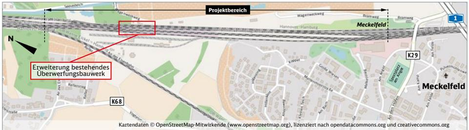
gleisige Strecke 1255 in Meckelfeld auf vier Gleise ausgebaut. Im Zuge dessen wird auch das vorhandene Überwerfungsbauwerk, eine Art *Brücke* zur Kreuzung von parallel verlaufenden Bahngleisen auf unterschiedlichen Höhen, erweitert.
