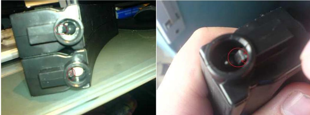
An der Oberseite der Magazine (an der Stelle, an der die BBs reinkommen) befindet sich ein Plastikteil welches verhindert, dass die Kugeln herausgedrückt werden wenn sich das Magazin nicht in einer Waffe befindet. Wenn man an diesem Plastikteil wenige Millimeter abfeilt, dann passen die Magazine einwandfrei.
