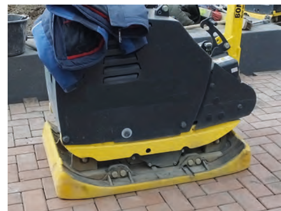
Bild 14: Vibrationsplatte mit planebener Unterseite Foto: SLG
