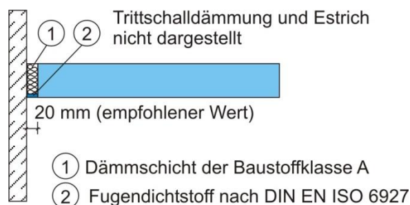
Bild 3: Fuge zwischen Deckenstirnseite und aufgehender Wand nach [10]
