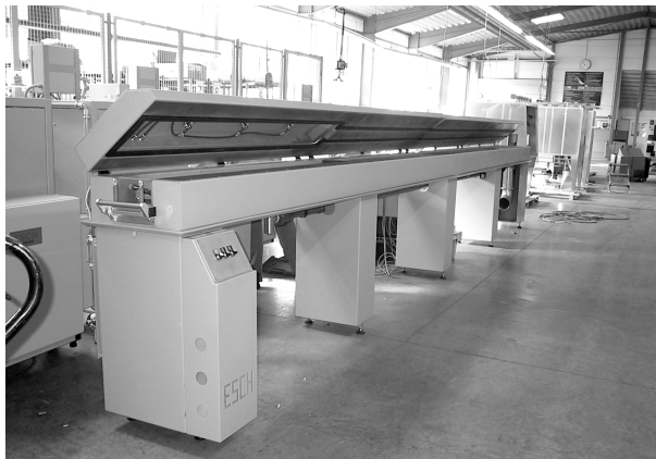
Bild 5.2: Kaltwassersprühkühlstrecke (Foto: Fa. HSM GmbH)
