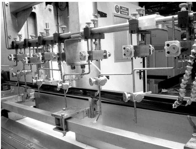
Bild 5.8: Pinselanordnung und Kleberzuführung (Foto: Fa. HSM GmbH)
