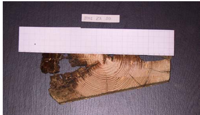
Abb. 165: Bohrkurve und Bohrgang Standort Widmayer, Zange 3 – 50 cm
