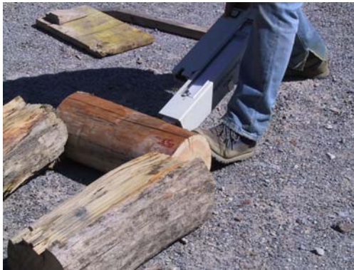
Abb. 151: Holzbohrung mit akkubetriebenem Resistograf M 300
