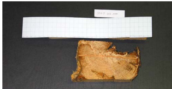
Abb. 162: Bohrkurve und Bohrgang Standort Widmayer, Längsholz vor, 3. von unten – 100 cm
