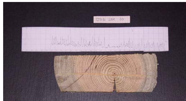
Abb. 171: Bohrkurve und Bohrgang Standort Finsterbach, Längsholz hinten, 1. von unten – 50 cm
