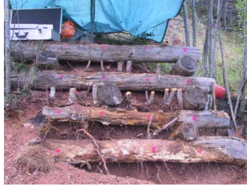
Abb. 150: Bohrraster (Abstand 0,5 m) – Standort 05 Widmayer
