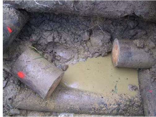
Abb. 177: Am Standort Finsterbach herrschen im Hanginneren fast aerobe Verhältnisse. Die hinteren Längshölzer weisen nach wie vor ausgezeichnete Holzqualität auf.
