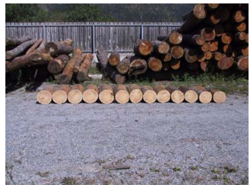
Abb. 149: Aufgeschnittenes Lärchenrundholz zur Resistographenbohrung im Pflanzgarten Prad.
