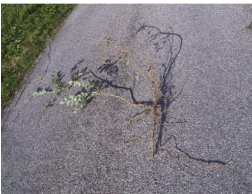
Abb. 145: Einlage 3, gebrochen ( Salix appendiculata – 3 J.)
