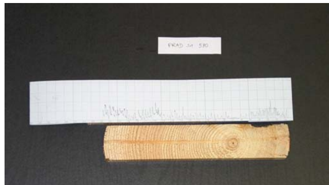
Abb. 156: Bohrkurve und Bohrgang Probe Prad Stamm 1 - 580 cm
