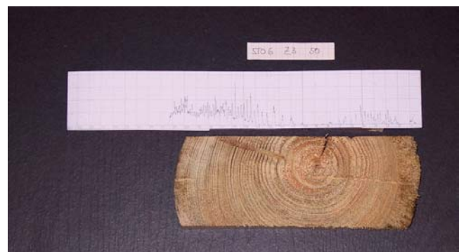
Abb. 173: Bohrkurve und Bohrgang Standort Finsterbach, Zange 3 – 50 cm
