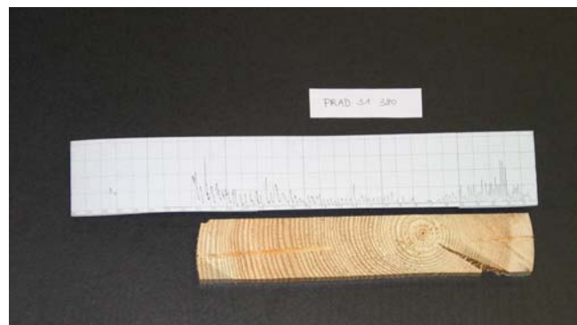
Abb. 154: Bohrkerne und Bohrgang Probe Prad Stamm 1 – 380 cm
