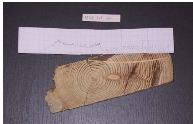
Abb. 167: Bohrkurve und Bohrgang Standort Finsterbach Längsholz vorne, 1. von unten – 50 cm
