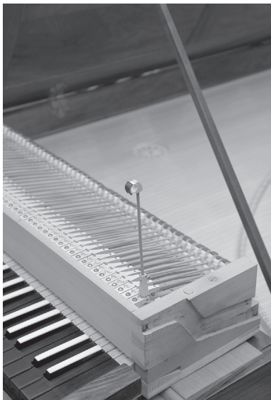
Mechanik des Silbermann-Flügels von 1749 (die Hammerköpfe bestehen aus Papierröllchen mit einem Leder-Flecken)
