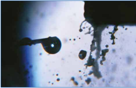
Bild 7: Austrittskante Zweistoffdüse – ohne Beaufschlagung von Ringspaltluft
