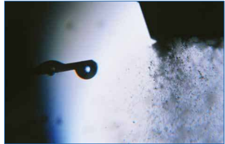
Bild 8: Austrittskante Zweistoffdüse – mit Beaufschlagung von Ringspaltluft
