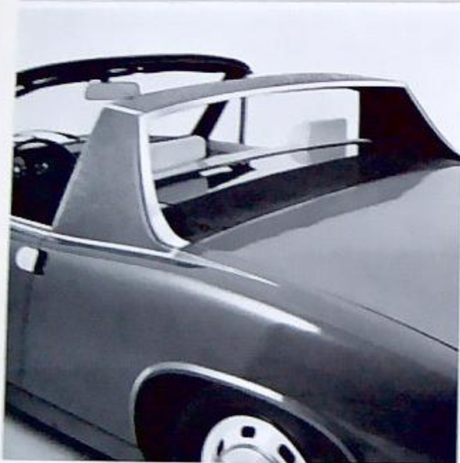
Sicherheitsbügel mit verankertem Ende Heckschürze
