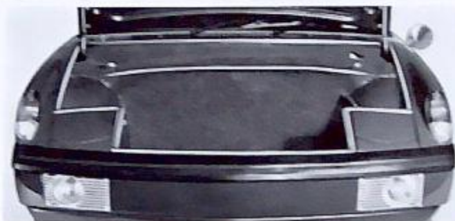
Kofferraum vorn: 210 Liter Kofferraum hinten: 80 Liter
