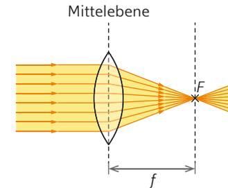
Die Mittelebene dient als Hilfslinie bei der Konstruktion. Bei dicken Linsen werden sogar zwei Mittelebenen eingezeichnet.
