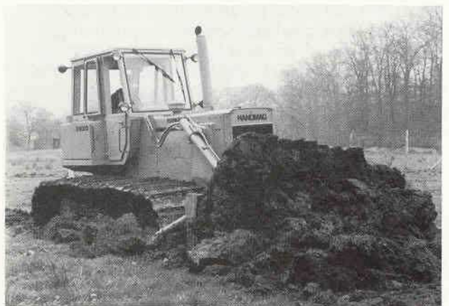
▲ D 600 D-Moorraupe (LGP-Laufwerk). 910 mm breite Bodenplatten mit nur 0,30 kg/cm 2 wirksamem Bodendruck für wenig tragfähigen Untergrund.
