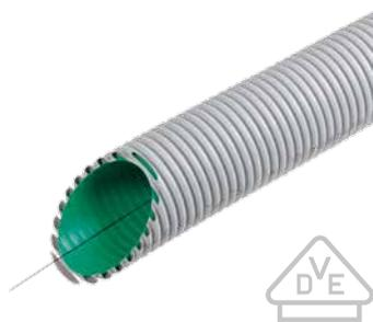
Kabelschutzrohr aus PE in Verbundrohrbauweise (außen gewellt, innen glatt) nach DIN EN 61386-24 (VDE 0605-24) mit transparenter Muffe (sanddichte Ausführung), halogenfrei, Farbe außen grau, innen grün. Hohe Scheiteldruck- und Schlagfestigkeit sowie Biegefähigkeit. Transparente Doppelsteckmuffen für sanddichte Verbindungen (SD). Mit Profildichtringen wasserdichte Verbindung (WD).
