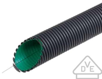
Kabelschutzrohr aus PE in Verbundrohrbauweise (außen gewellt, innen glatt) nach DIN EN 61386-24 (VDE 0605-24) mit transparenter Muffe (sanddichte Ausführung), halogenfrei, Farbe außen schwarz, innen grün. Hohe Scheiteldruck- und Schlagfestigkeit sowie Biegefähigkeit. Transparente Doppelsteckmuffen für sanddichte Verbindungen (SD). Mit Profildichtringen wasserdichte Verbindung (WD).
