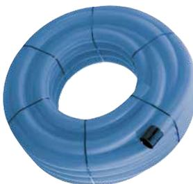
Gewelltes ungelochtes Dränagerohr aus PP; Farbe blau; Ringsteifigkeit  $\geq 10 \text{ kN/m}^2$  („SN 10“); in Anlehnung an DIN 1187, ÖNORM B5140 und DIN 4262-1.
