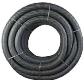
Gewelltes Vollsickerrohr aus PE; Farbe schwarz; Ringsteifigkeitsklasse SN 8; Schlitzfläche  $\geq 50 \text{ cm}^2/\text{m}$ ; Schlitzbreite 1,2 mm. In Anlehnung an DIN 1187, ÖNORM B5140 und DIN 4262-1.
