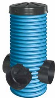
Handliches, universelles Schachtsystem aus PE-HD, DN 300; Farbe blau. Mit 3 Zuläufen DN 200 und Sandfang; inkl. 1 Blindstopfen DN 200 sowie begehbare Abdeckung mit Arretierung.
