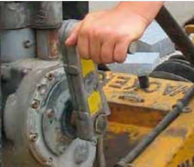
Starten der Rüttelplatte mit Sicherheits- kurbel, alternativ mit Batteriestart
