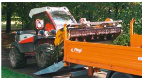
Ständig dabei – fest angebaute Auffahrschienen mit Gasdruckfedern zur leichteren Bedienung
