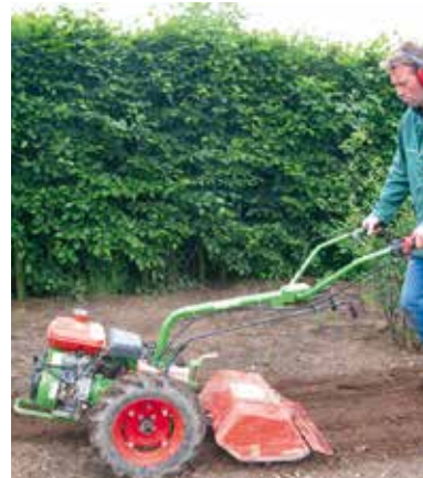
Einachsschlepper mit angebaute Bodenfräse
