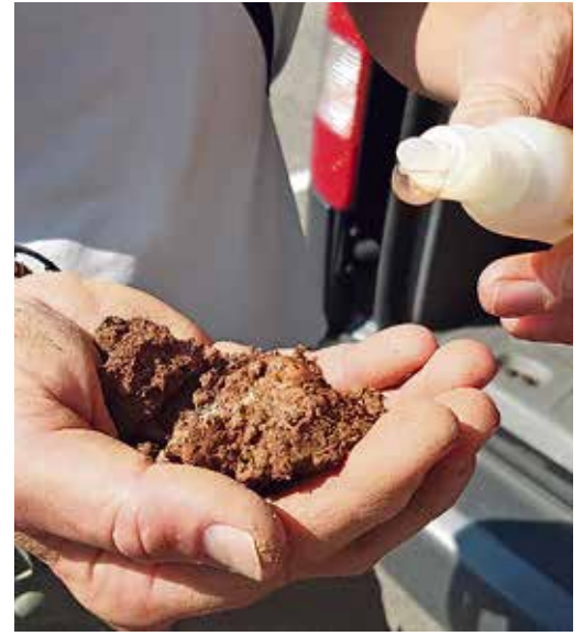
Bodenproben werden mit Salzsäure getestet.
